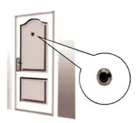
2. Установите винты (В), выбранные в зависимости от толщины двери, в корпус внешней камеры (С), но не затягивайте их туго. Установите глазок (С) в подготовленное место, первым делом проведя шлейф через отверстие и убедившись, что нанесенная на тыльную сторону камеры стрелка направлена вверх.
