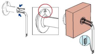
3. Возьмите стальной кронштейн (D) и убедитесь, что стрелка на нем указывает вверх, затем проведите шлейф через отверстие в кронштейне. Проведите винты через отверстия в кронштейне, чтобы разместить его вровень с дверью. Затяните винты, чтобы зафиксировать стальной кронштейн и наружную камеру.
