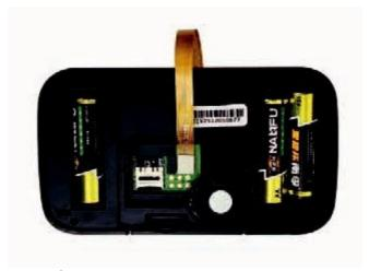
6. Установите крышку отсека для батарей, при этом шлейф размещается в небольшое отверстие на крышке.
